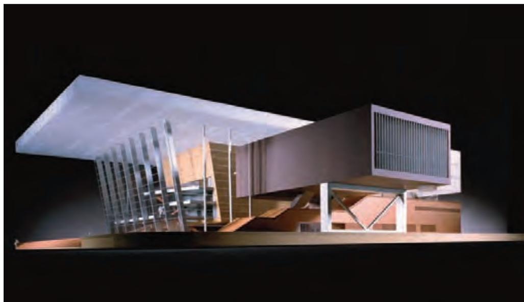
Fig. D.1.1.3 - L'impianto rivela tre piani sospesi a sottili cavi metallici che mediano la presenza del blocco in cemento lasciato a vista.
